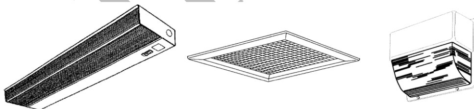
Слика 6.9 Примери на светилки со рефракторски оптички систем [6]
