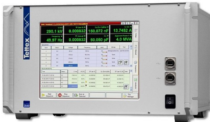
Слика 10.7. Компактен преносен мост за мерење многу мали диелектрични загуби (Tettex 2840)
