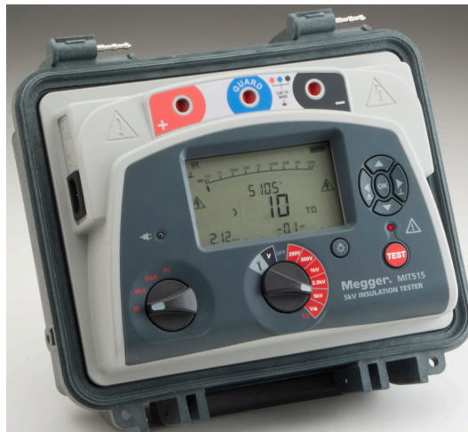
Слика 10.16. Мереен инструмент за мерење на отпорот на изолација – мегаомметар (Megger MIT 515)
